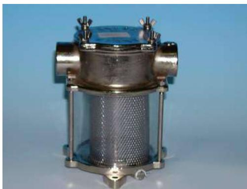
Filtri acqua in ottone nichelato, tiranti in acciaio inox e tubo in poliacrilico centrifugato. **Verificare periodicamente il grado di usura dello zinco di protezione anodica**
